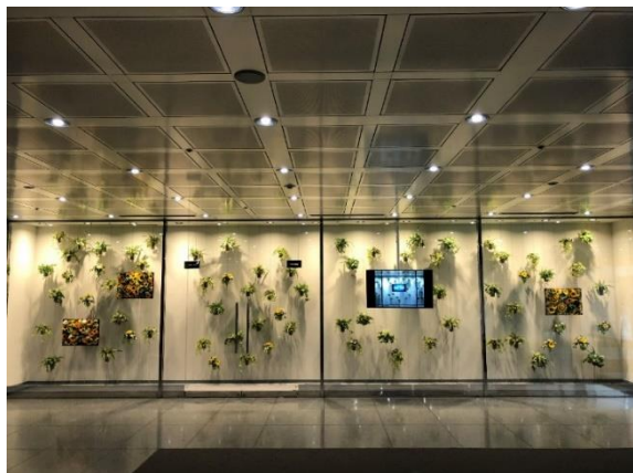
上端下端にインテリア・アンカーレールをビス止めで取り付け。 ハンギングポット以外に、ピクチャレールで使用するハンガーフックを取付け、フラワーディスプレイも同じワイヤー上に吊るしています
